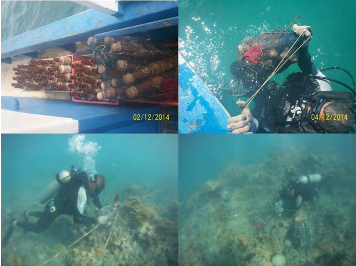
Figura 16: Armadilhas de sedimentos e substituição das mesmas através de mergulho autônomo.
