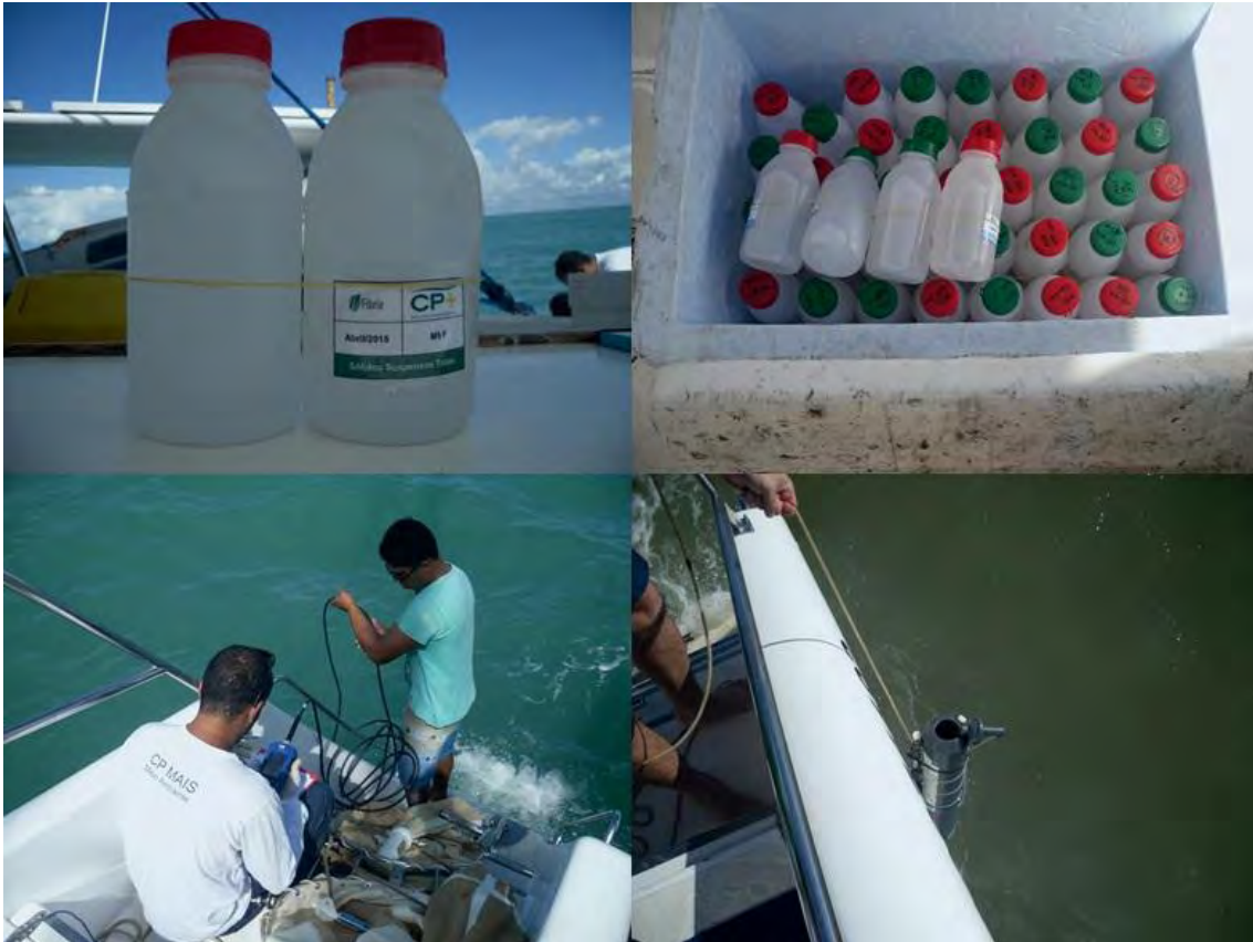
Figura 13: Monitoramento físico-químico da água: coleta de água na superfície e fundo, armazenamento das amostras de água, sonda multi parâmetro, e garrafa de coleta de água.
