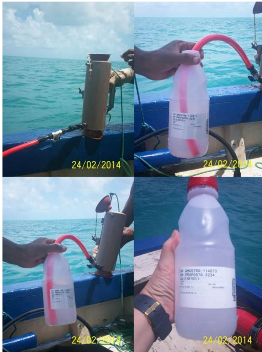
Figura 8. Procedimento de amostragem de água para o monitoramento espacial da turbidez e detalhe da etiqueta de identificação das garrafas para o armazenamento da água amostrada.
