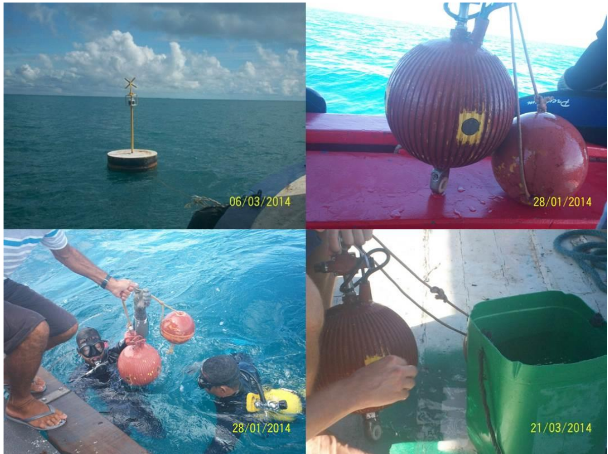
Figura 6. Resgate dos ondógrafos para aquisição de dados e manutenção dos equipamentos; e boia de sinalização.
