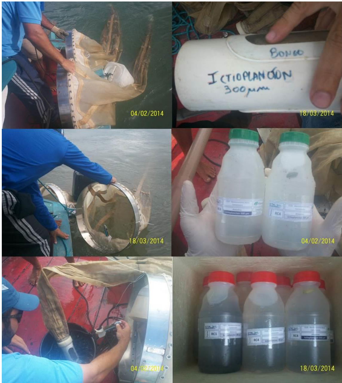
Figura 16. Detalhes da rede bongô para a coleta do zoôplancton estuarino e dos frascos de armazenamento do conteúdo coletado na subsuperfície.
