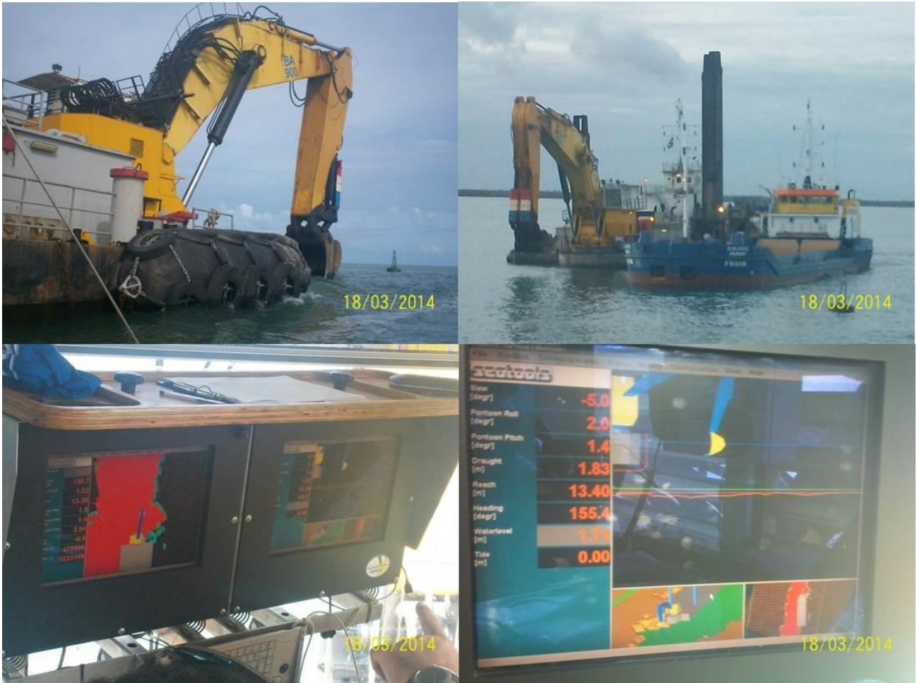
Figura 25. Dragagem No Woman No Cry, do tipo escavadeira, auxiliada por um batelão para o depósito do sedimento arenoso e detalhe do software utilizado para a navegação e posicionamento do braço de dragagem.
