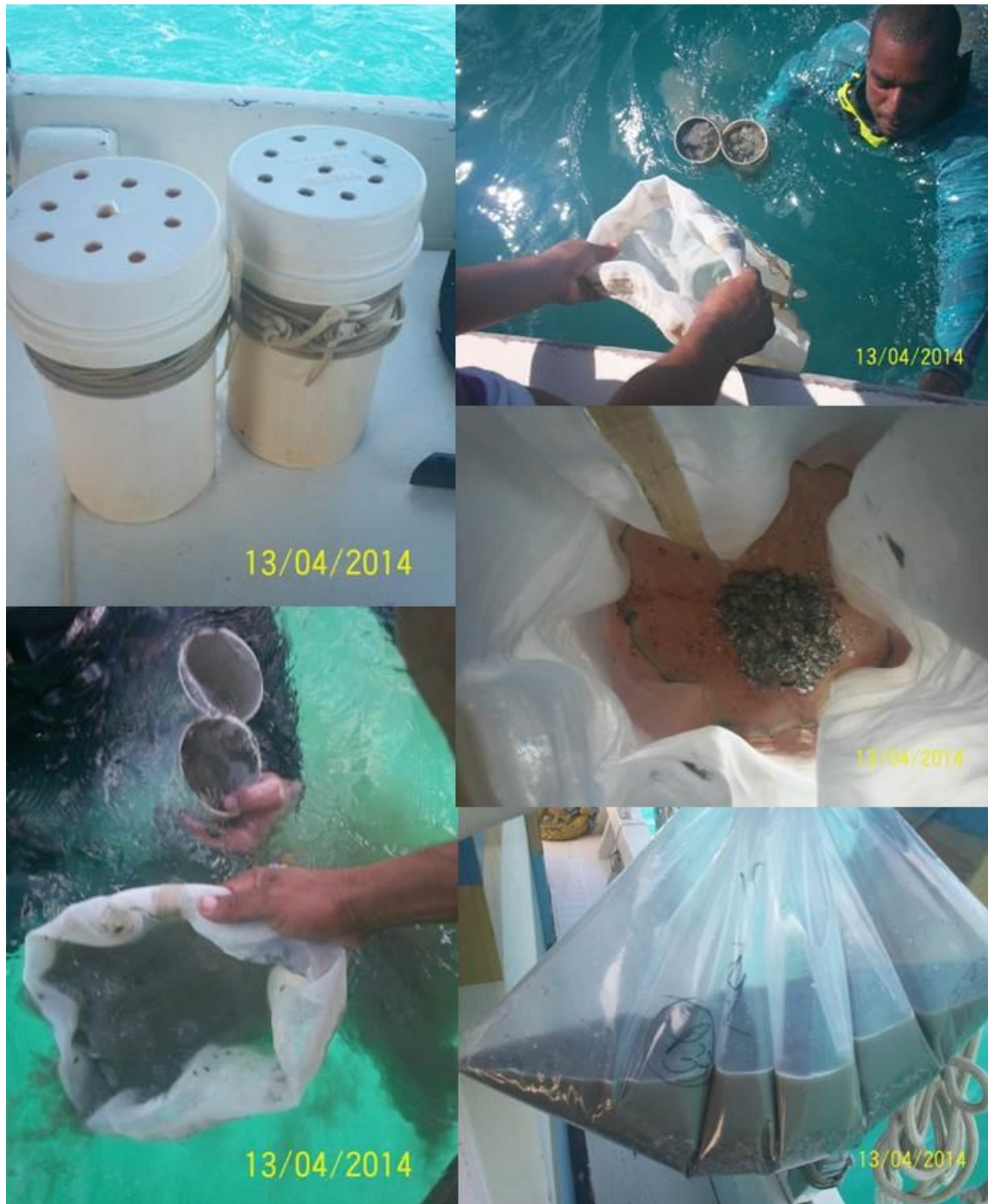
Figura 13. Coleta manual da infauna, com corers de PVC, através do mergulho livre; triagem das amostras em saco de rede com abertura de malha 0,5 mm e acondicionamento das amostras com sedimento lamoso em sacos e potes plásticos.
