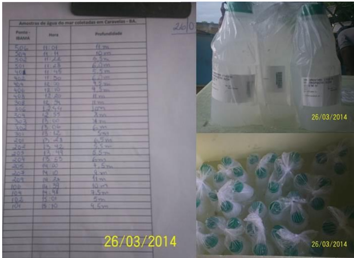
Figura 9. Planilha de campo com os pontos e profundidade das amostras de fundo, e condicionamento das amostras em caixas com gelo.
