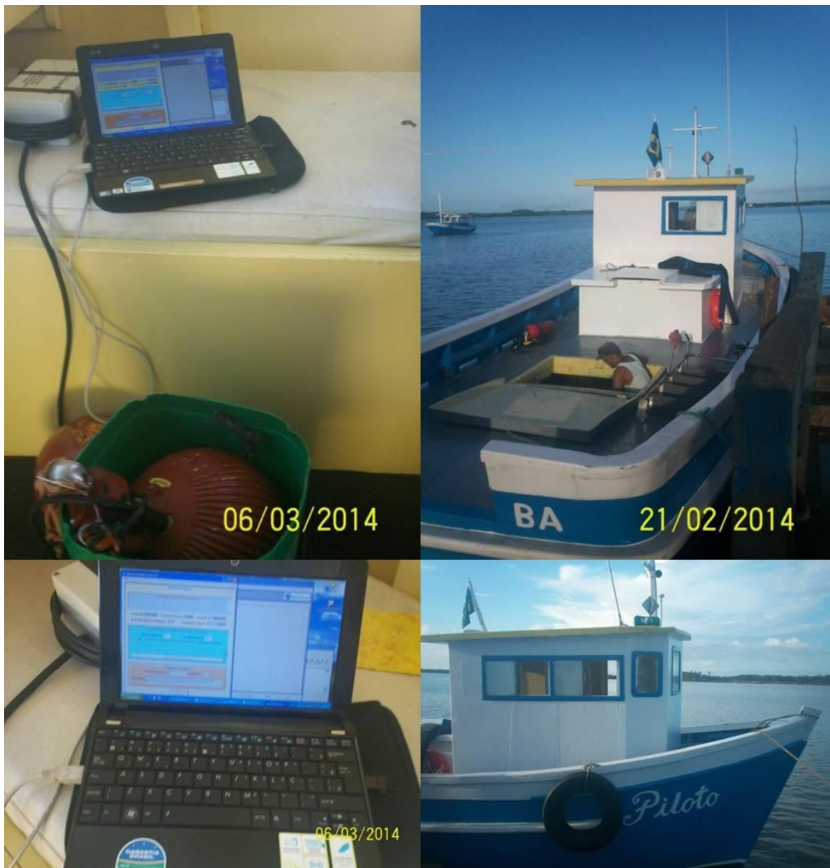
Figura 7. Aquisição dos dados de concentração de sólidos em suspensão (CSS), obtidos pela leitura dos sensores do Ondógrafo S4 nas estações #106 e #506 e embarcação utilizada no monitoramento da turbidez.
