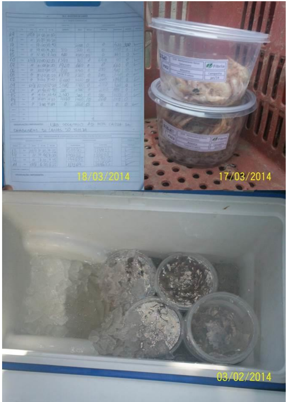
Figura 15. Planilha de campo e armazenamento e conservação das amostras em caixas com gelo.
