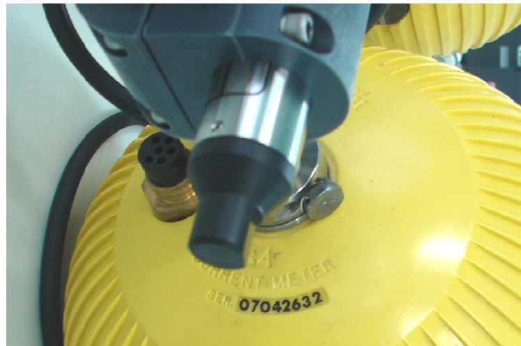
Figura 3 - Detalhe do sensor OBS acoplado ao S4ADWi
