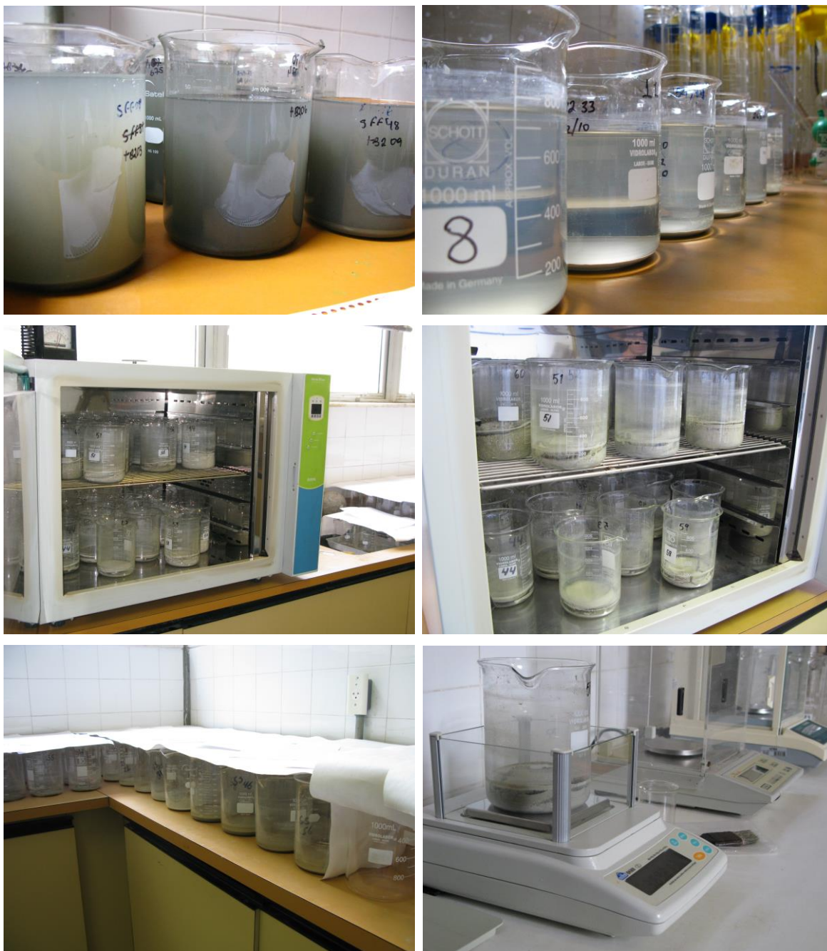
Figura 14 – Ilustração do procedimento realizado com amostras de sedimento retiradas das armadilhas. Após ser transferido para beckers o sedimento decanta e passa por sucessivas lavagens para retirada de sal. Após sifonadas, as amostras são levadas para estufa a 50 graus até secagem completa do sedimento para então serem pesadas.
