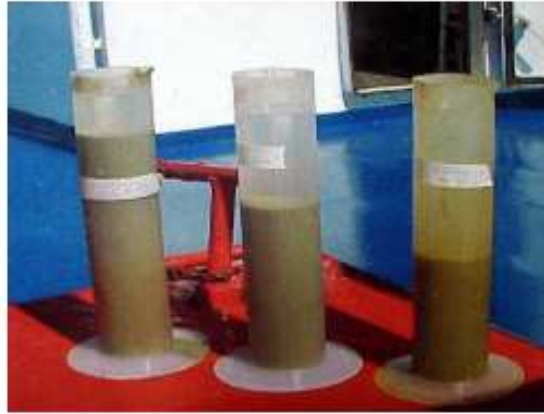
Figura 6-3 – Provetas após decantação
