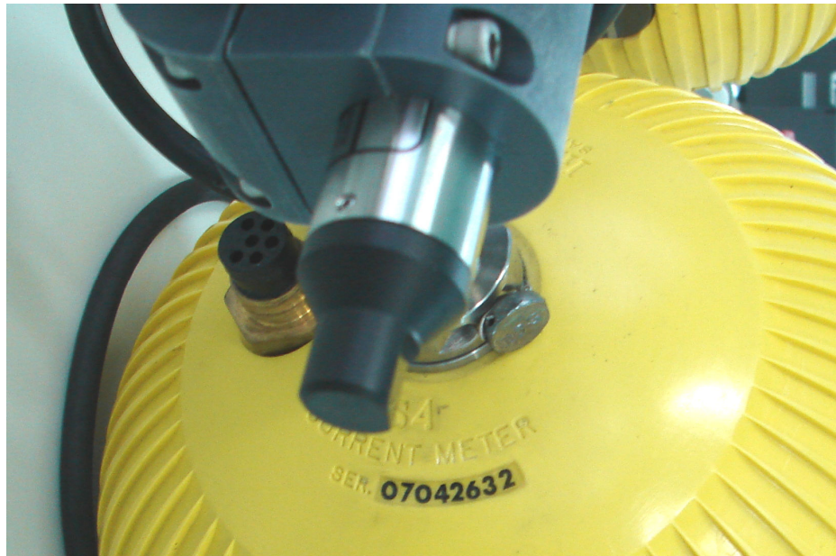
Figura 5.1.5-5 - Detalhe do sensor OBS acoplado ao S4ADWI
