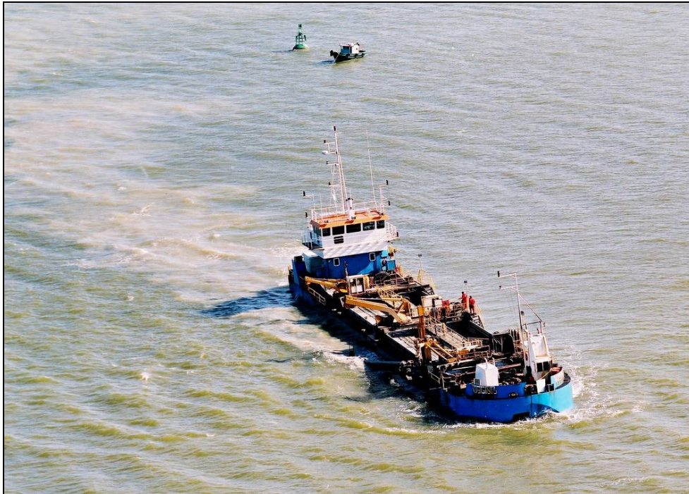
Figura 4.1-2: Vista aérea de uma draga hopper operando em Caravelas.
