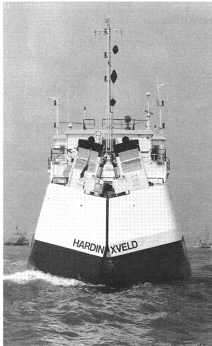
Figura 3.6.4-13 – Draga do tipo “split hull”
