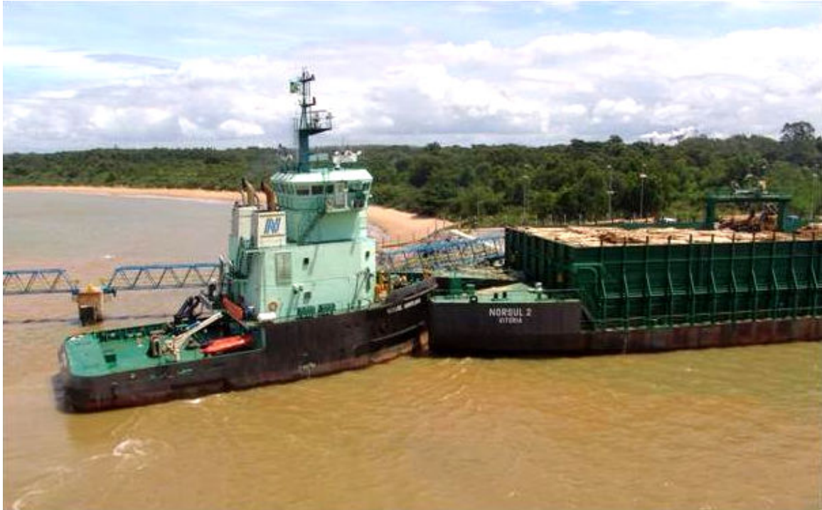
Figura 3.5.1-3 – Empurrador realizando acoplamento na barcaça, no Terminal de Caravelas
