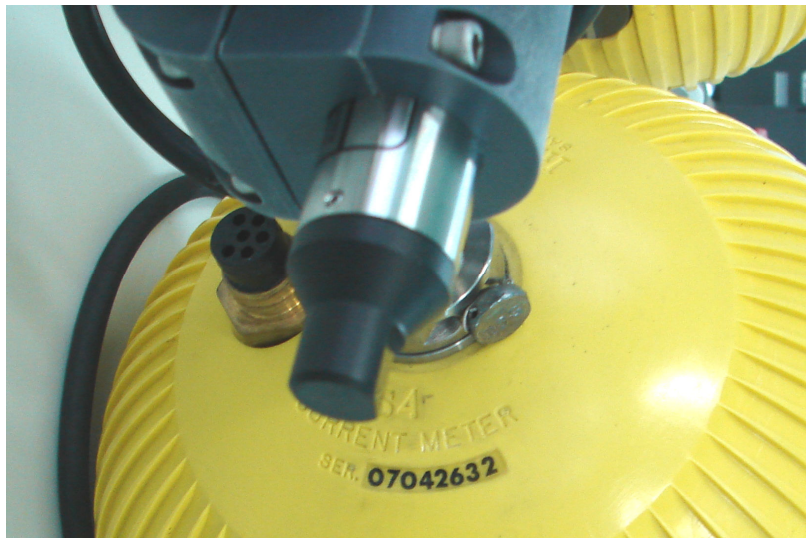
Figura 5.1.4-25 – Detalhe do sensor OBS acoplado ao S4ADWI
