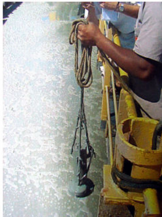
Figura 3.6.3-5 – Utilização de prumo de medição
