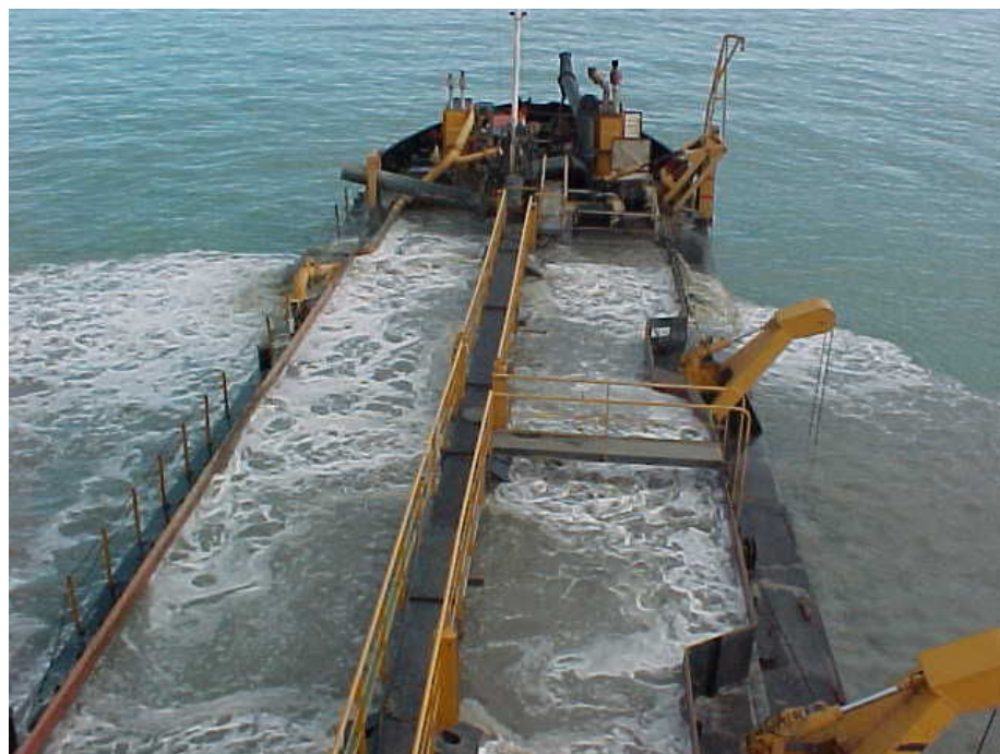
Figura 3.6.7-3 – Overflow sendo executado
