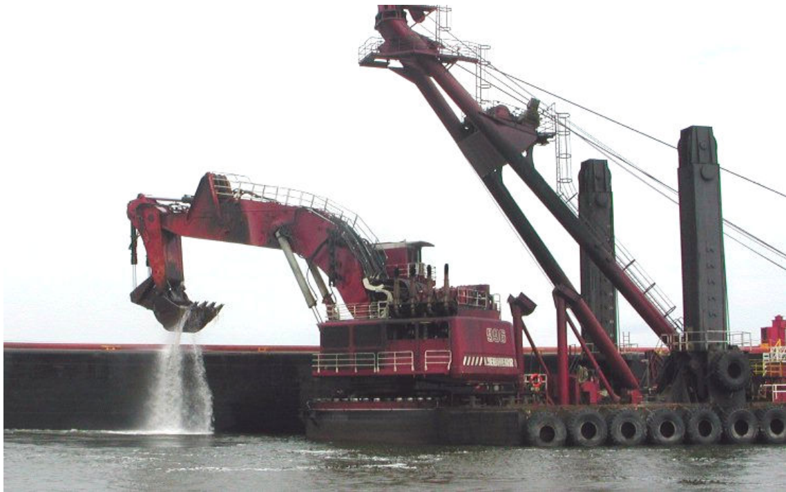
Figura 3.6.4-3 – Draga Mecânica New York (backhoe dredger) dragando na Baía de Newark, EUA
