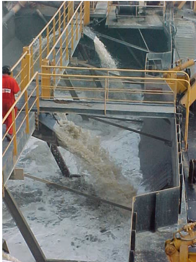
Figura 3.6.7-2 - Carregamento da cisterna com sedimentos arenosos
