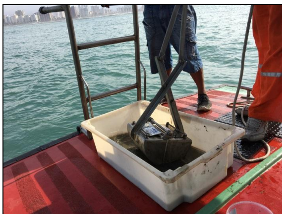
Figura 2.6-4 - Busca fundo tipo Van Veen em aço inoxidável utilizado na coleta
