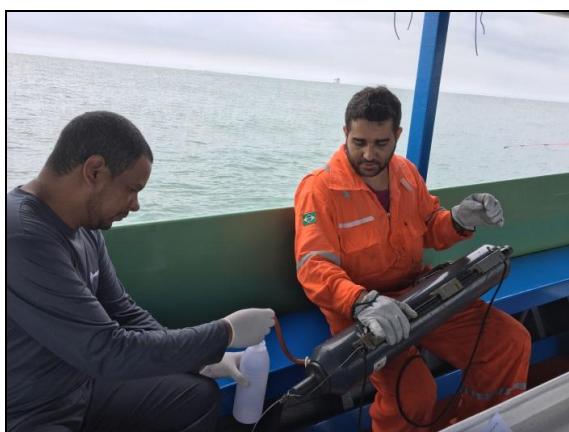
Figura 2.6-5 - Garrafa do tipo Niskin de 10 L utilizada na coleta
